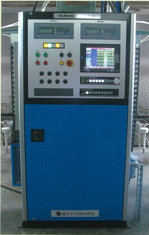
塗装制御盤(SUNAC4000EX)
