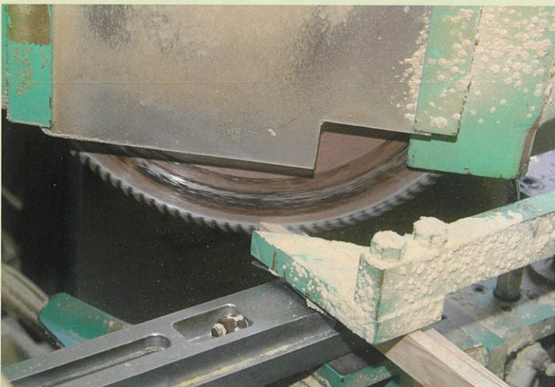
自動留め切り加工で角を45度に切断
