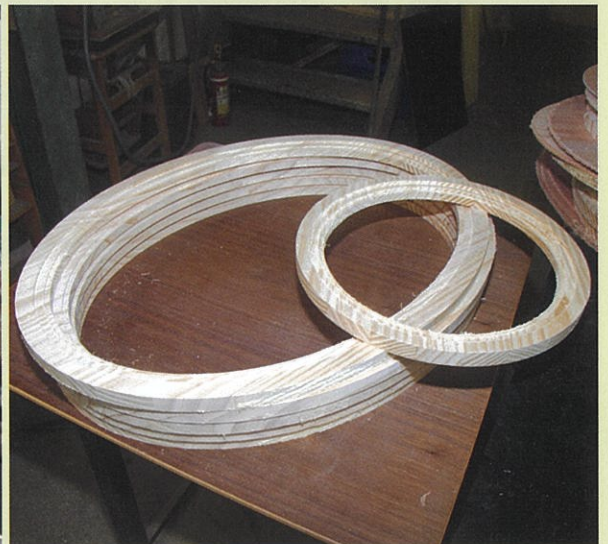
最新のNC加工機により円形や楕円形などに木材を精密に成型加工する
