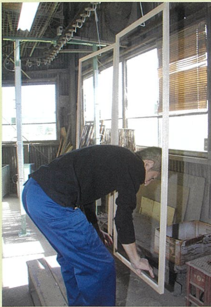
塗装ラインに木枠を着荷
